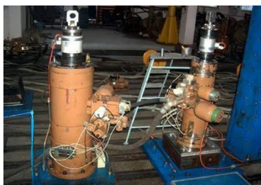
Fig.6 - Cilindri hidraulici, dispuși pentru acționarea pe verticală
