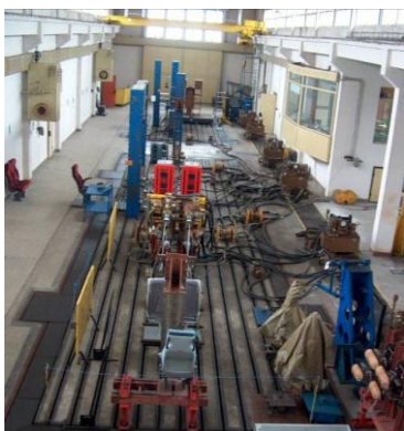
Fig. 1 - Platforme de încercare cu sisteme de izolare a vibrațiilor
