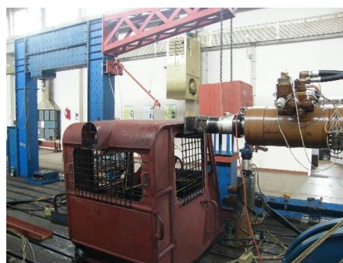
Fig. 13 - Testarea ROPS a structurilor de protecție
