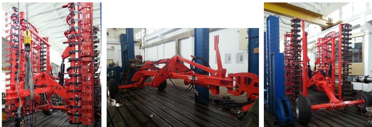
Fig. 3 – Testarea la vibrații în transport a mașinilor agricole
