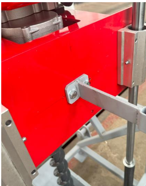
Figura 6 Placa de susținere și sistemul de ghidare
