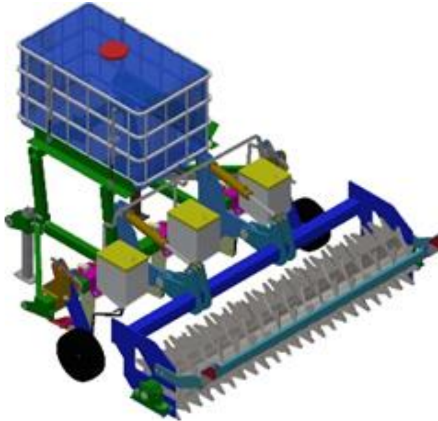
Fig. 14 - Echipament de prelucrare în profunzime a solului (scarificator), prevăzut cu echipament de inoculat microorganisme în vederea refacerii lanțului trofic al solului
