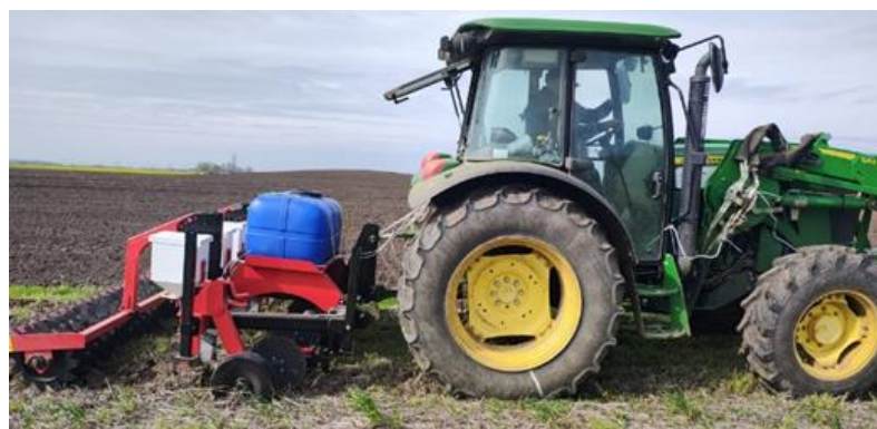
Fig. 7 – Aplicarea biofertilizanților în sol cu echipamentul de afânat solul la înființarea culturii de porumb
