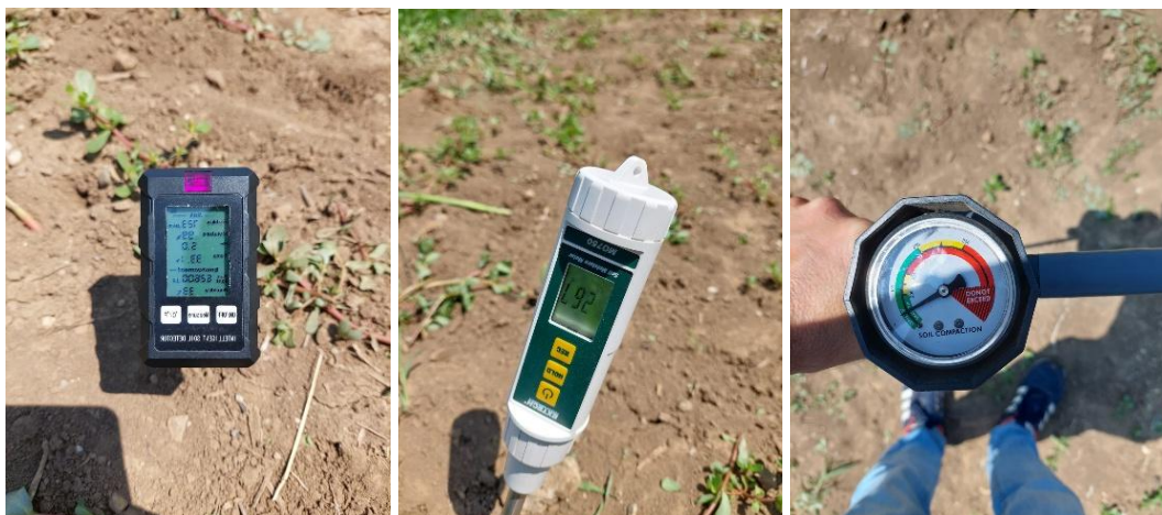
Fig. 12 Determinarea gradului de umiditate, compactare, temperatura si PH solului
