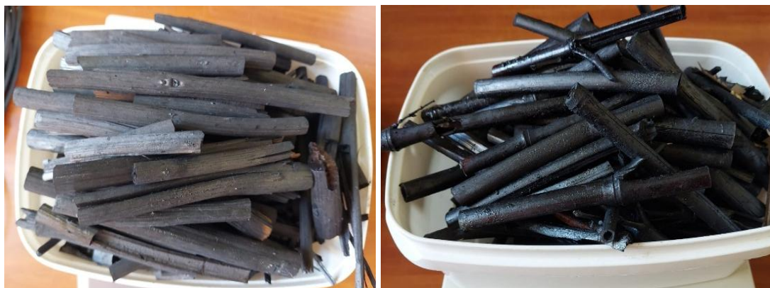
Fig. 9 Biochar obținut din tulpini de cânepă și bambus
