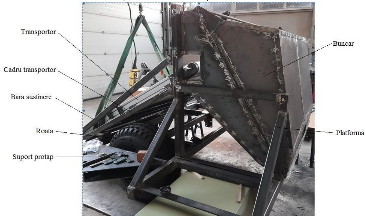
Fig.2. Cadrul mașinii pe care au fost montate preliminar, unele din principalele subansambluri
