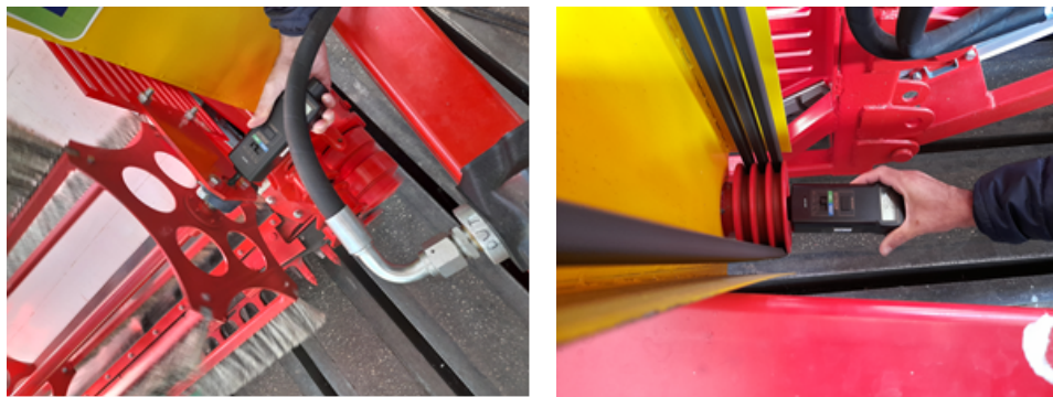
Figura 2. Determinarea turației rabatorului, a transmisiei cu curele, care acționează bielele mecanismului aparatului de tăiere
