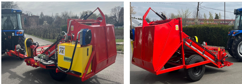
Figura 1. Mașina de recoltat plante medicinale MRPM-0
