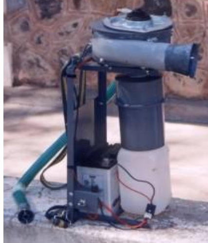
Fig.3.: Echipament de recoltat Șofrănel acționat de un motor electric cu baterie (Sursă: A.K. Rajanvashi, 2004)
