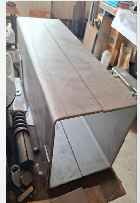
Corp Reactor realizat din 2 piese U
