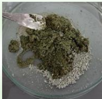
Figura 6. Model funcțional din amestecuri de zeolit, culturi bacteriene și hidrolizate de lână
