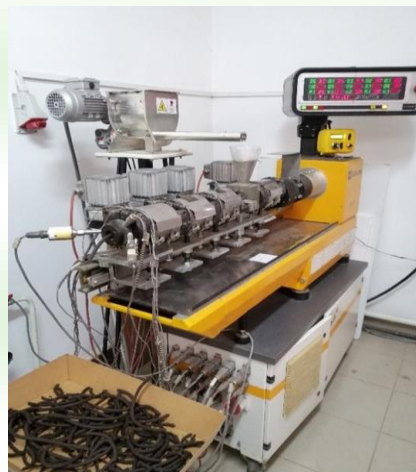
Figura 4. Extrudare material pentru obținere fertilizanți pe bază de lână
