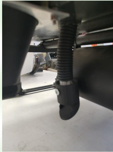
Fig.6. Sistem dozare cu precizie ridicata a îngrășămintelor minerale
