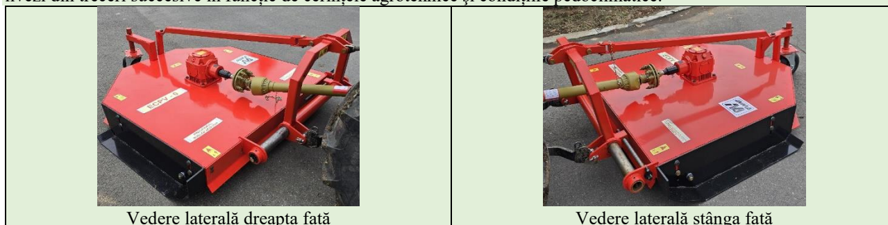
Fig. 2. Model experimental de echipament tehnic inovativ de cosit intervalul înierbat dintre rândurile de viță de vie și pomi fructiferi
