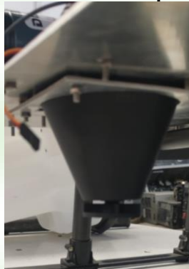
Fig.7. Sistem dozare a semințelor cu precizie ridicată în zone greu accesibile
