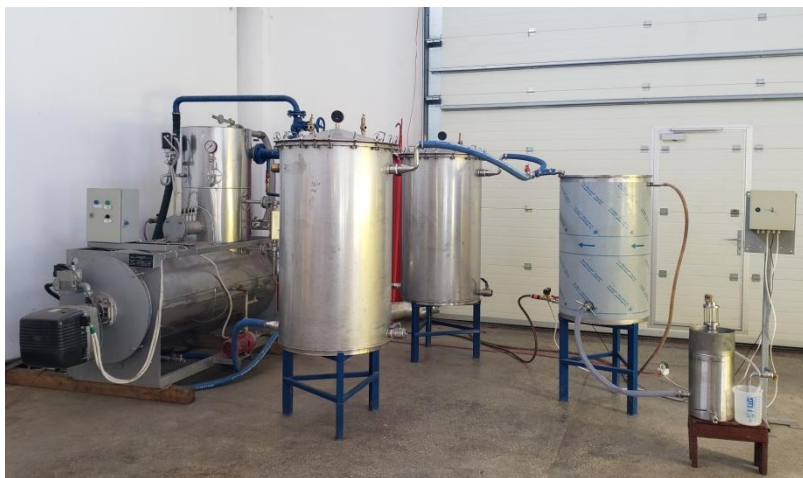
Instalația de extracție a uleiurilor volatile din plante medicinale, cu flux alternativ - IEA 2x500
