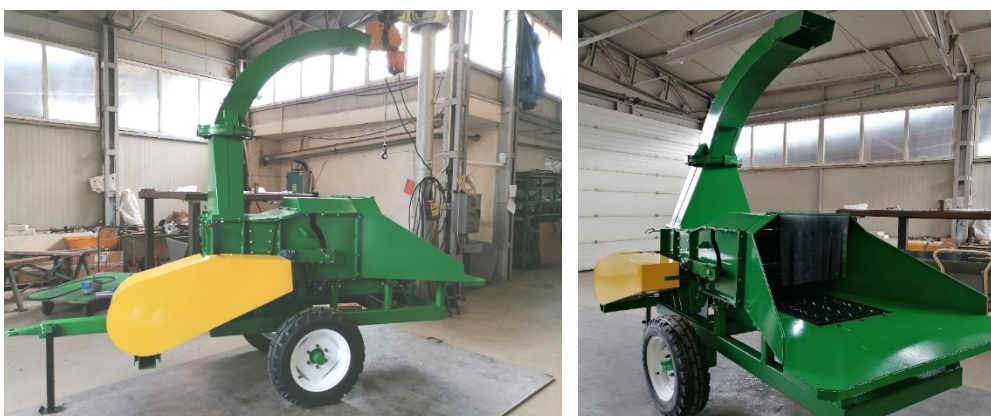
Fig. 6. Echipamentului tehnic de tocare a resturilor vegetale, TRL
