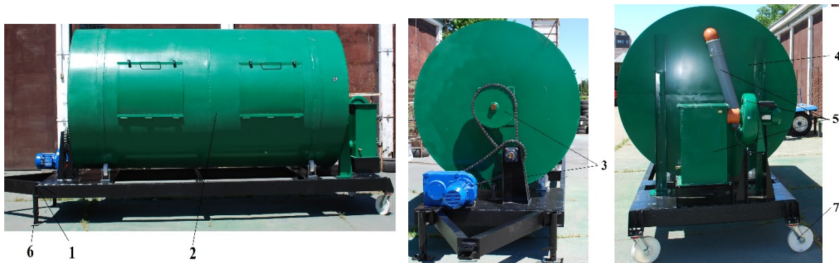
Fig. 5 – Instalația de recuperare și transferul energiei termice rezultate în procesul de compostare – IRTC
