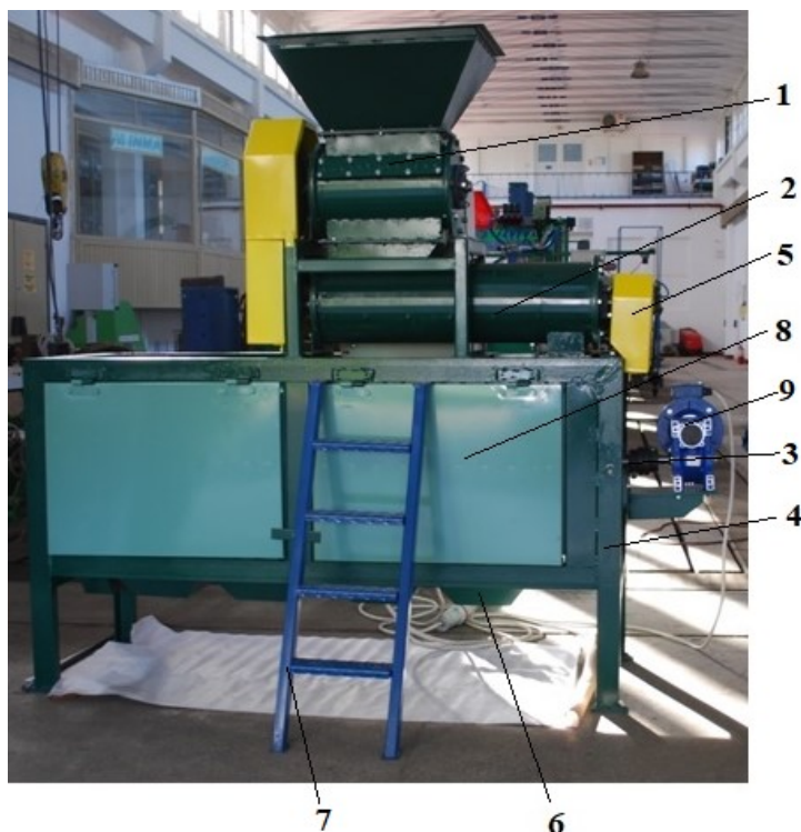
Fig. 3. Echipament tehnic pentru separarea pulpei de sămânța de cătină, ESSC Legendă: 1. Sistem de decompactare materie primă; 2. Sistem de detașare a semințelor de pulpă; 3. Sistem de separare; 4. Cadru suport; 5. transmisii cu curele trapezoidale; 6. Pâlnii de evacuare; 7. Scară; 8. Uși laterale; 9. Instalație electrică de acționare
