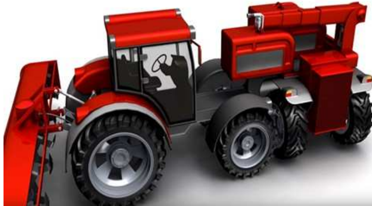
Fig. 2 Concept de tractor electric împreună cu robotul de înlocuire a bateriilor https://www.youtube.com/watch?v=LuzBzfo7dzs
