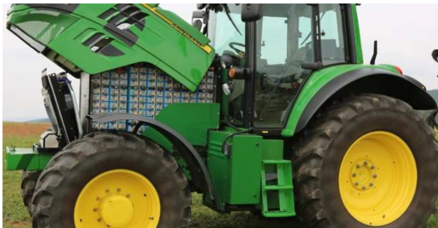
Fig. 8 Tractor electric JD cu un set de baterii
