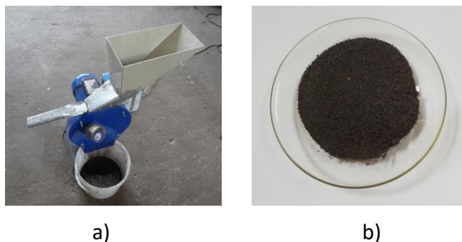
Fig. 8. Pregătirea amestecului de componente solide a) macinare, b) amestec produs
