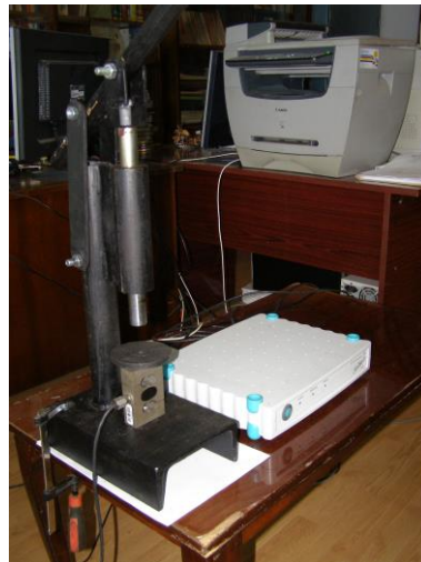
Fig. 11. Echipament pentru încercări la compresiune.
