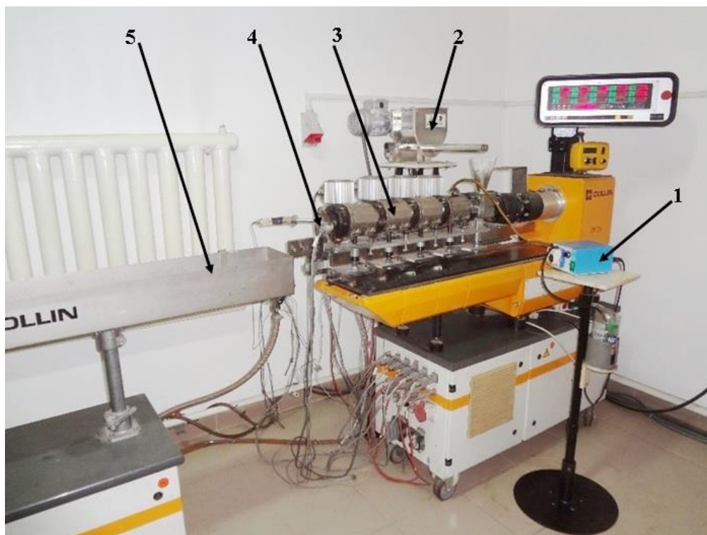
Fig.7. Instalația de realizare a materialului biocompozit eco-fertilizant pe bază de turbă
