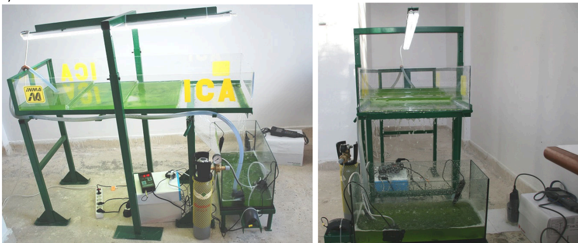
Fig.1. Instalația pentru cultivarea algelor în sistem deschis, tip cascadă-Model funcțional -Simbol ICA-
