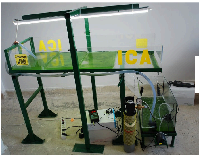
Fig.14. Instalația pentru cultivarea algelor în sistem deschis, tip cascadă Model funcțional -Simbol ICA
