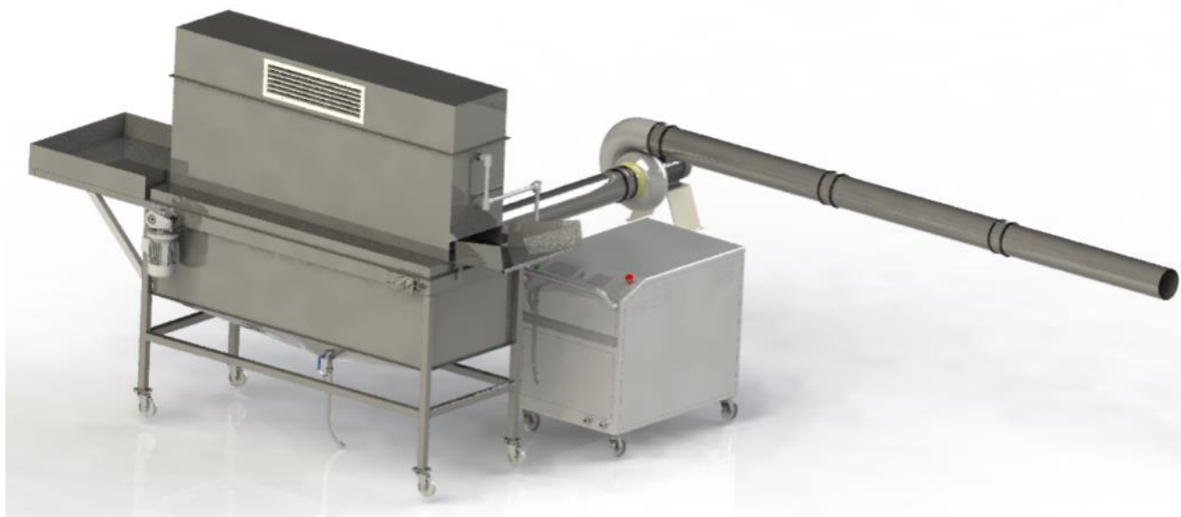
Fig. 1 Echipamentul pentru decontaminare cu ozon in solutie apoasa – EDO
