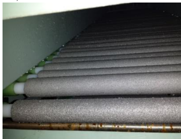
Fig. 3 Acoperirea rolor de transport cu un material moale si poros
