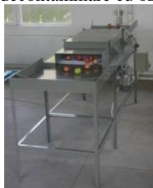
Fig. 3 Instalație de decontaminare a suprafețelor exterioare ale produselor horticoale, IDPH
