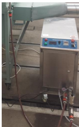
Fig. 6 Cuple rapide pentru cuplarea și decuplarea sistemului de distribuție la generatorul de ozon
