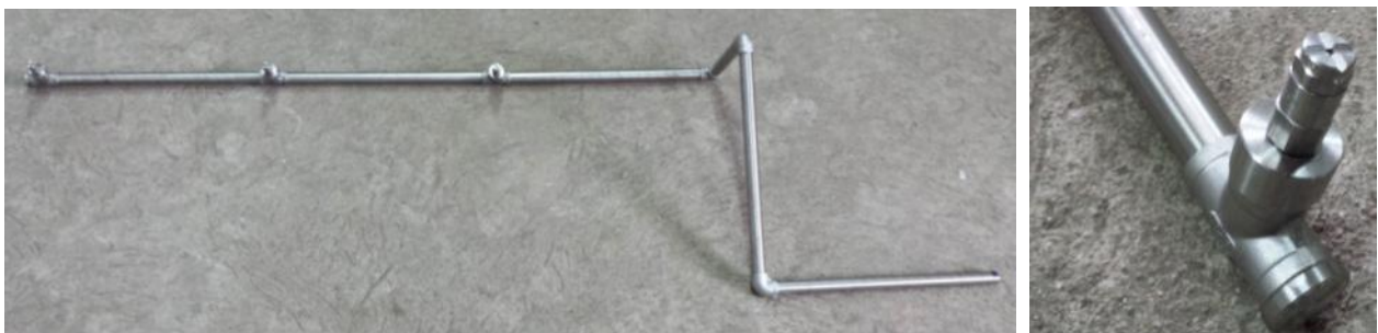
Fig. 10 Sistem de distributie a ozonului in solutie apoasa
