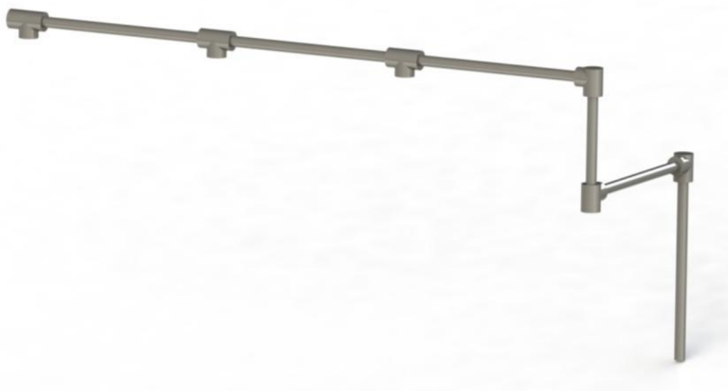
Fig. 11 Sistem de distribuție a ozonului în soluție apoasă
