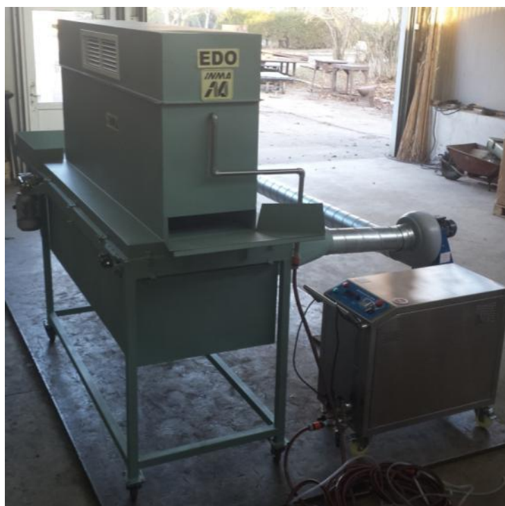
Fig. 1 Echipamentul pentru decontaminare cu ozon in solutie apoasa – EDO
