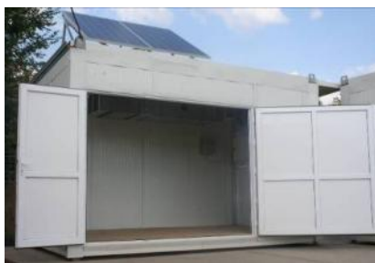
Fig. 4 Instalatie automatizata pentru depozitarea temporara a produselor horticole, IDT
