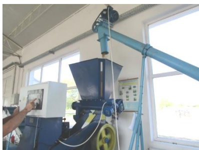
Fig 3. Transport elicoidal înclinat TEI 85, buncărul IVSS -2.0 și sistemul de alimentare SA
