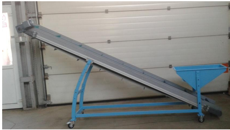
Fig. 2 Transportor mobil cu banda TMB 150
