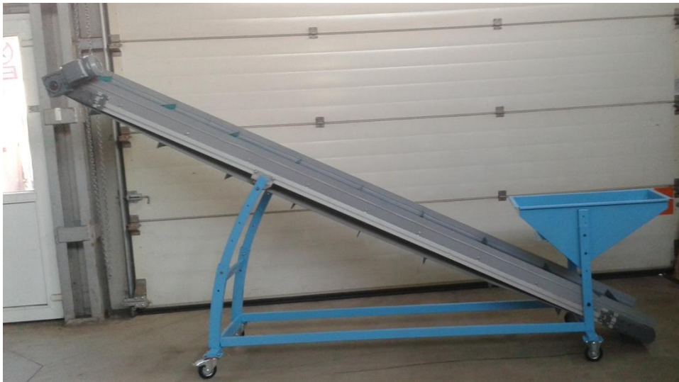
Fig. 3. Transportor mobil cu banda TMB 150
