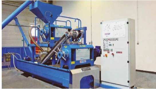
Fig. 1 Instalație mobilă de presare, extrudare și filtrare ulei tip Universal Compact, firma FARMET
