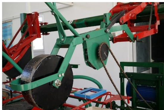
Fig.2 Secția de semănat a SPM-0 montată pe stand
