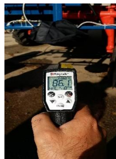
Fig.4 Determinarea temperaturii agentului termic
