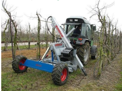
Fig. 7. Dispozitiv de tăiat rădăcini la pomi realizat de firma BORECO din Olanda
