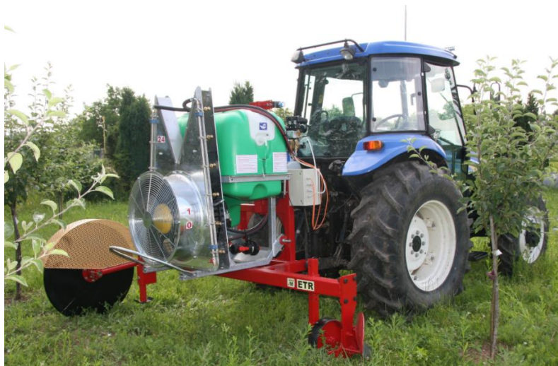
Fig. 20. Model experimental de echipament tehnic pentru lucrarea solului pe rândul de pomi fructiferi, concomitent cu tăierile de rădăcină pentru moderarea creșterii de lăstari și fertilizarea foliară de precizie-ETR
