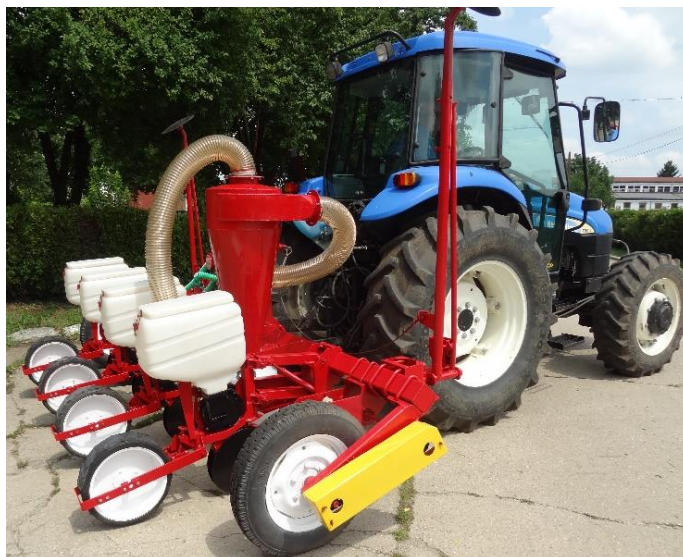
Model experimental de sistem eco-inovativ prevăzut cu „deflector” pentru semănat plante prășitoare
