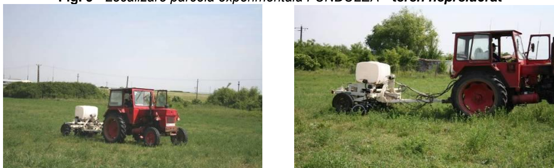
Fig. 10 - Platformă VERIS 3150 în lucru, în teren neprelucrat
