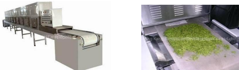
Fig. 1.31 - Uscător cu microunde Kang Gang a) Vedere din perspectivă b) Uscarea ceaiului verde cu uscător KG
