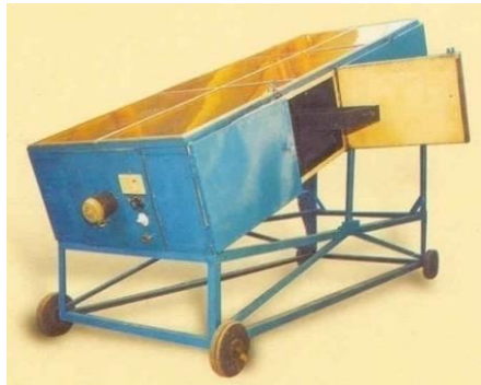
Fig. 1.21 - Uscător solar pentru gogoșile de mătase tip CIAE Bhopal, India
