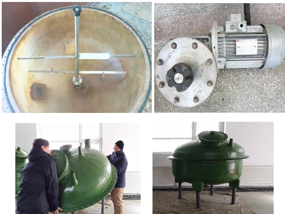
Fig. 26. Digestorul cu sistemul de omogenizare pentru procesul de digestie anaerobă umedă
