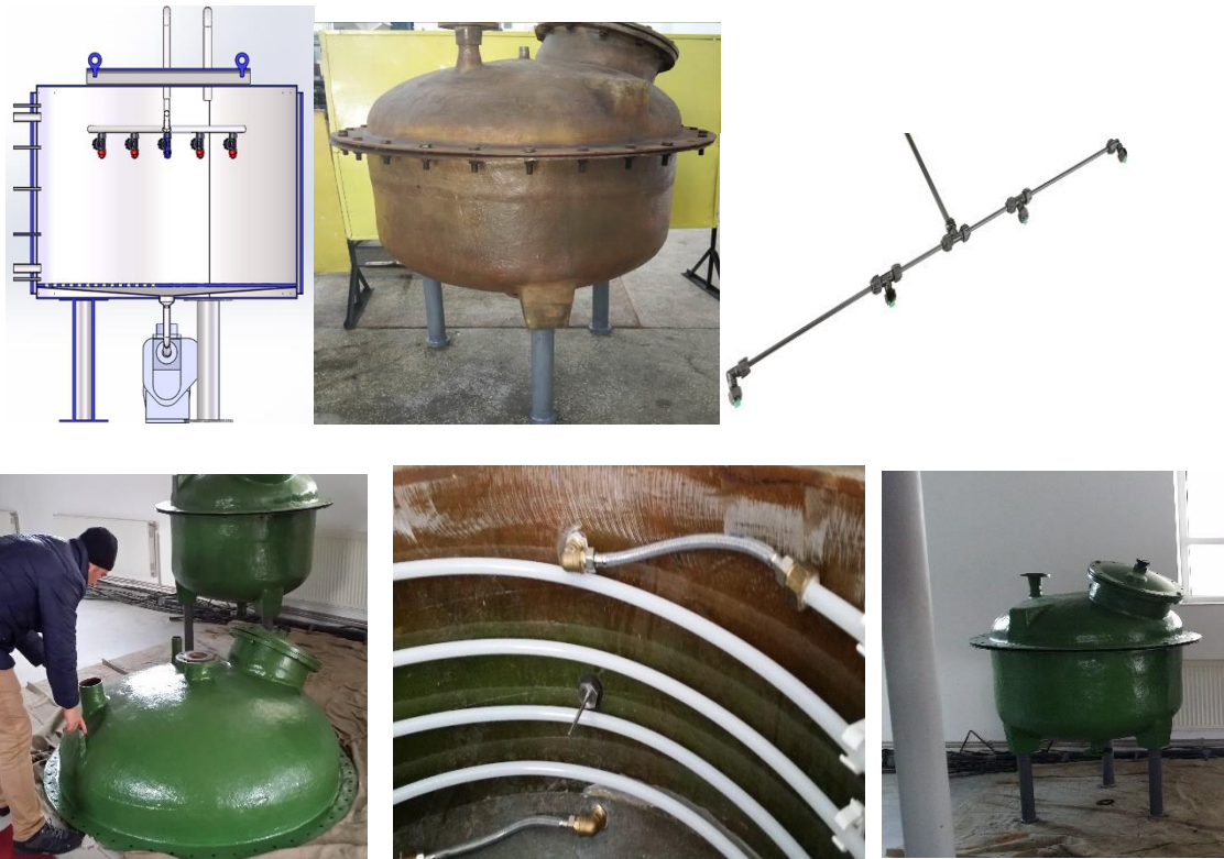
Fig. 25. Digesterul cu sistemul de pulverizare pentru procesul de digestie anaerobă uscată
