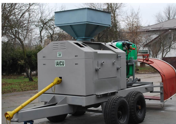
Fig. 1 - Instalație de aplatizat în vederea însilozării cerealelor în stare umedă, IAICU-0
