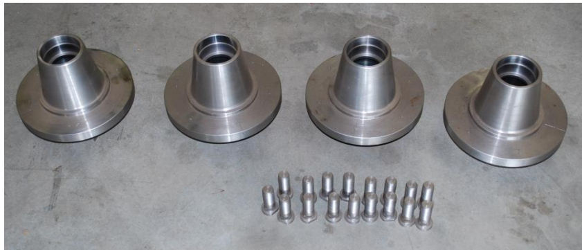
Fig.4 Butuc, IAICU - 6.2.4 și Bolț rotă, IAICU - 6.2.6
