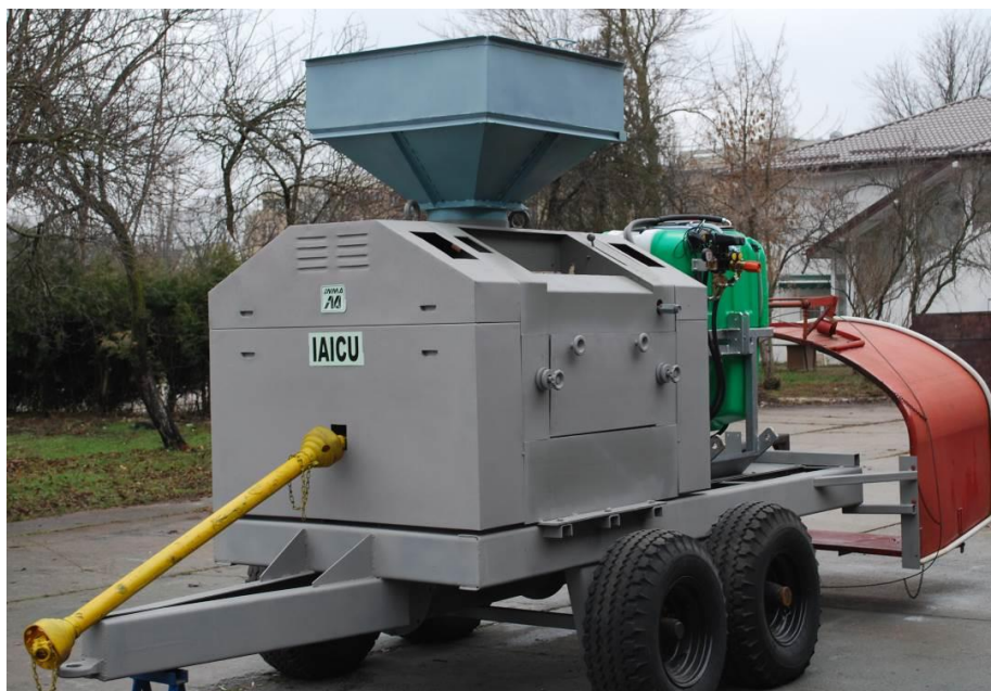
Fig. 2 Instalația de aplatizat în vederea însilozării a cerealelor în stare umedă – IAICU
