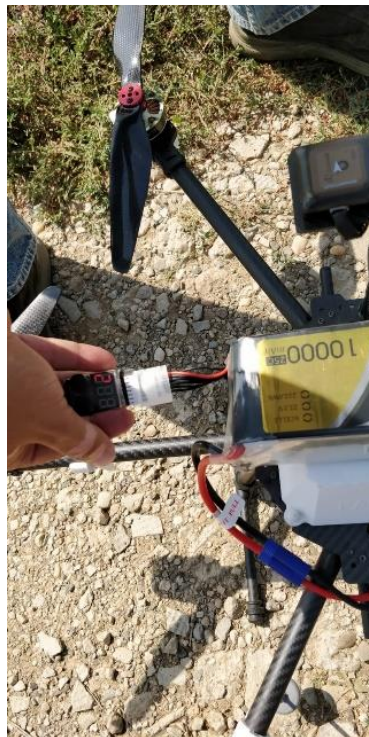
Fig. 26. Acumulator Li-Po: 3 x Li-Po 6S 10000mAh
