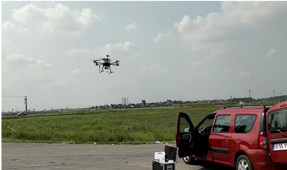
Fig.9. Sistem aerian de monitorizare spectrală de tip dronă agricolă
