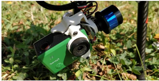
Fig. 22. Camera foto Mapir Survey 3 cu GPS încorporat
