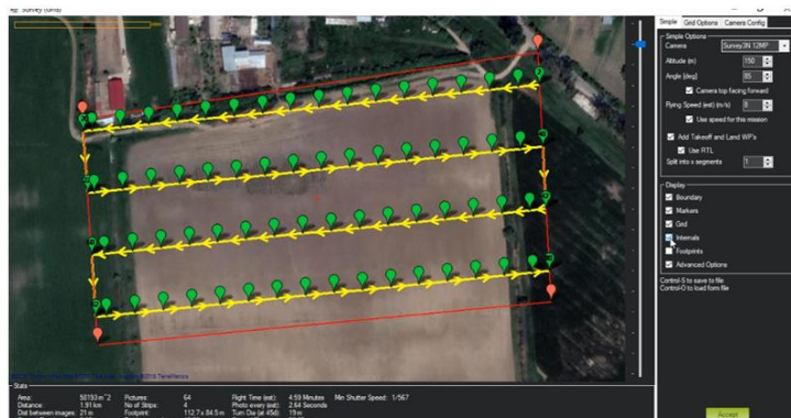
Fig.14. Afișarea punctelor unde camera multispectrală va efectua pozele de monitorizare a culturii
