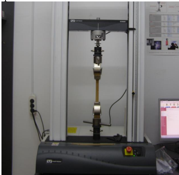
Fig.5. Masina de incercat la tractiune-compresiune INSTRON-3366- aspect din timpul incercarilor
