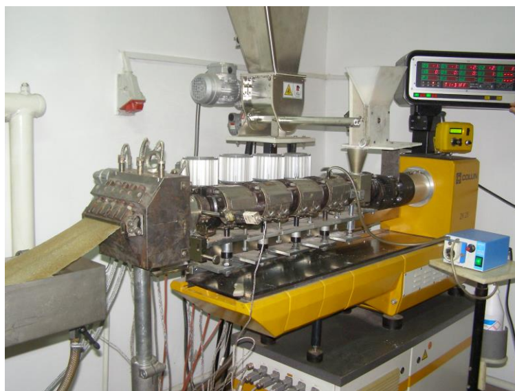
Fig. 2 Instalatia de extrudare si formare a materialului compozit-in lucru
