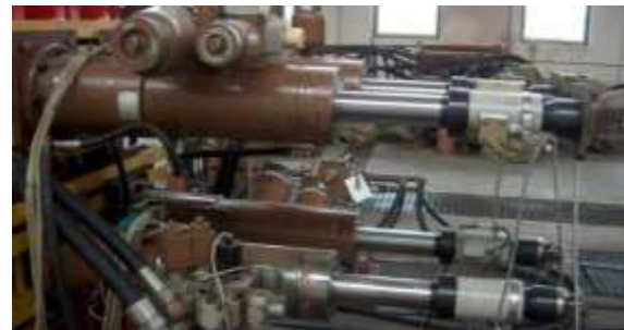
Fig. 5 - Cilindri hidraulici, dispuși pentru acționarea pe orizontală
