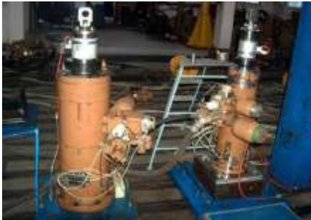
Fig. 4 - Cilindri hidraulici, dispuși pentru acționarea pe verticală
