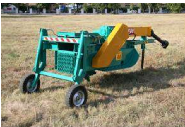
Fig. 1.- Echipament tehnic pentru lucrat solul în vederea împăduririi – EPI
