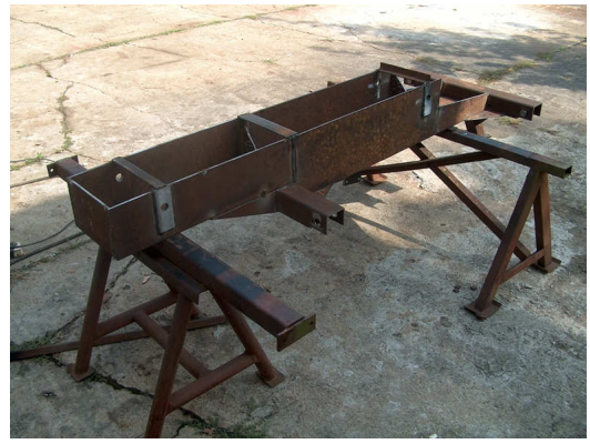
Fig.3 .Subansamblu cadru ghidaj-a) si corp glisant-b) din constructia modelului experimental al echipamentului de extras plante cu balot de pamant
