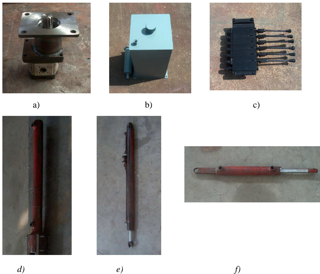
Fig.5 .Subansamble ale instalatiei hidraulice de actionare a echipamentului de extras plante cu balot de pamant a)-pompa hidraulica; b)-rezervorul de ulei; c)-distribuatorul hidraulic; d)-cilindul hidraulic pentru actionarea sapelor; e)- cilindrul hidraulic de ridicare a corpului glisant; f)- cilindru hidraulic de actionare a bratelor suport sape
