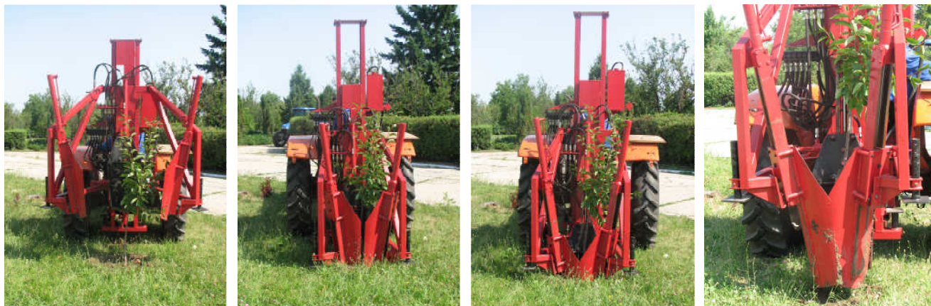
Fig. 6. Aspecte ale fazelor procesului de lucru la extragerea plantelor cu balot de pamant la radacina
