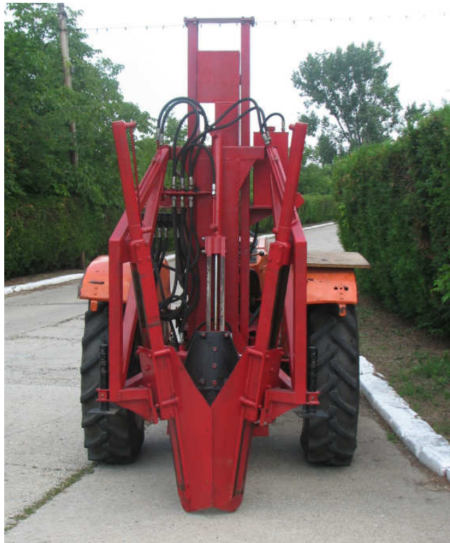
Fig.10. Model experimental definitivat EXPLANT 500 montat pe tractorul U 445
