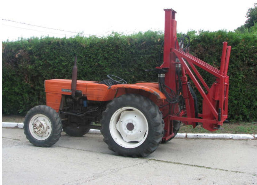
Fig. 2. ME echipament tehnic de extras plante cu balot de pamant
