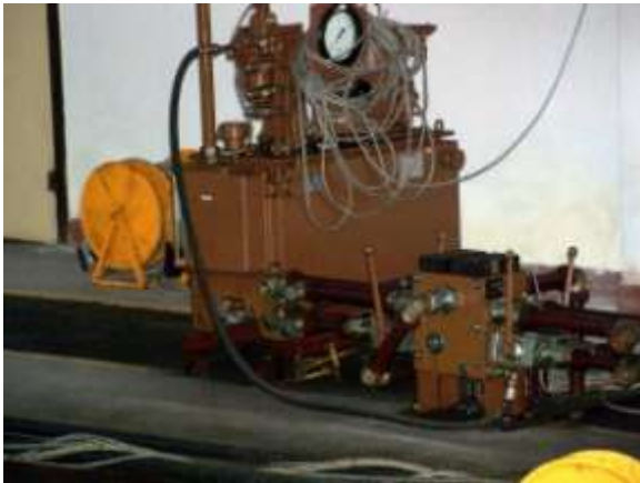
Figura 8 - Instalația hidraulică de alimentare și distribuție
