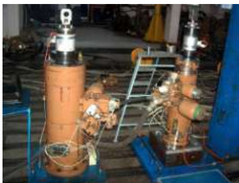
Figura 4 - Cilindrii hidraulici, dispuși pentru acționarea pe verticală
